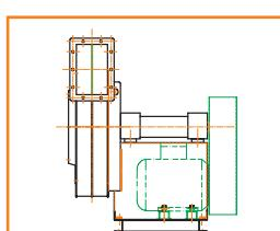
Esec. 12 – semplice aspirazione, accoppiamento a cinghie. Girante a sbalzo su albero di trasmissione sostenuto dalla base. Ventilatore e motore sostenuti da telaio di fondazione.
