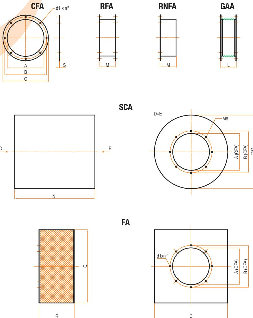
**CFA** > Contro flangia lato aspirazione - *Inlet counterflange - Contre bride aspirante - Ansaugender Gegenflansch - Contrabrida aspirante*
