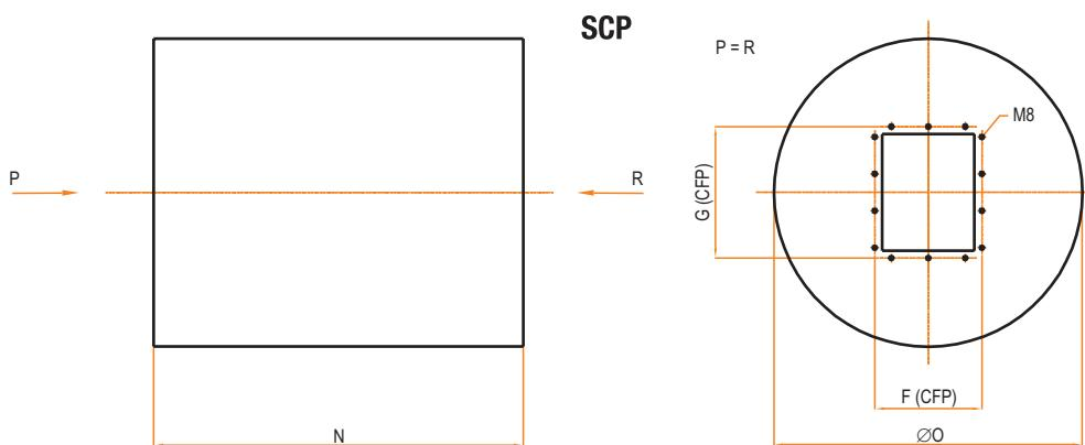
**CFP** > Contro flangia lato premente - *Outlet counterflange - Contre bride de compression - Drückender Gegenflansch - Contrabrida impelente*
