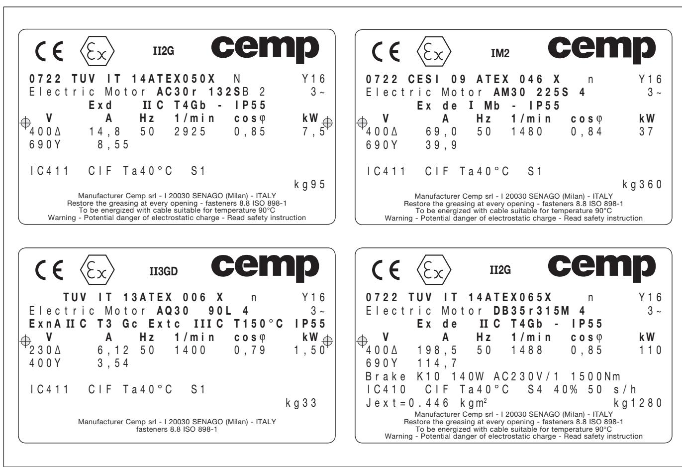
Abbildung 2A - Beispiel eines Typenschildes
